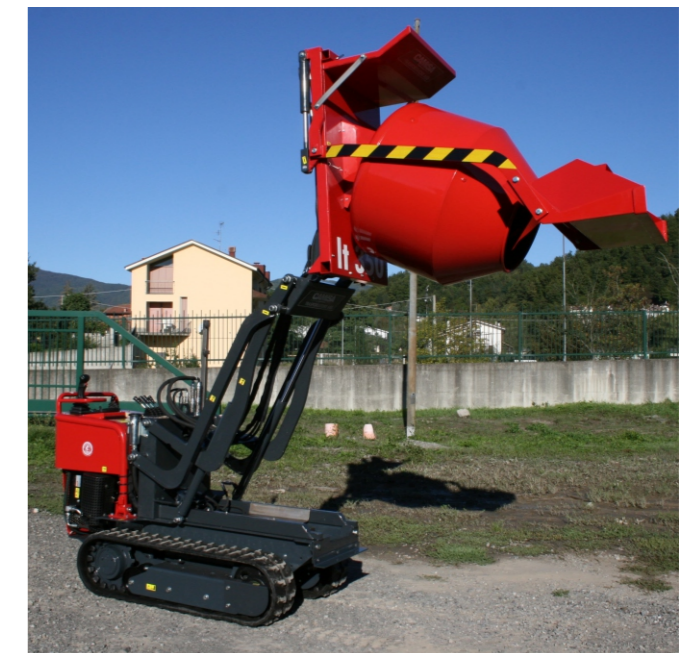
Pianale di carico con elevatore, pala autocaricante e betoniera Lt. 350 Lifter bed, selfloader and concrete mixer Lt. 350 Plateau de caryement avec élévateur, pelle autochargeuse et bétonnière Lt. 350 Hochentlehnung für Ladeschaufel und Betonmischmaschinen Lt. 350 Plataforma de carga con elevador, pala de autocarga y hormigonera Lt. 350
