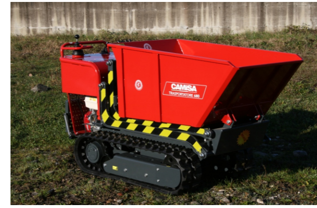
Pianale di carico con elevatore scarico mm. 1500 -1700 Lifter bed unloading mm. 1500 - 1700 Plateau de caryement avec élévateur déchargement mm. 1500 - 1700 Hochentlehnung mm. 1500 - 1700 Plataforma de carga con elevador, altura de descarga mm. 1500 - 1700
