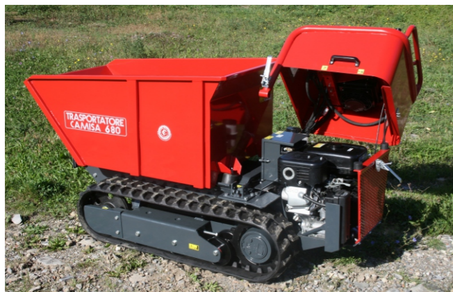
Cruscotto ribaltabile per manutenzione Tilttable dashboard for maintenance Tableau de bord inclinable pour l'entretien Kontrollen-Dashboard Armaturen Brett für Wartung Panel de controles inclinable para el mantenimiento
